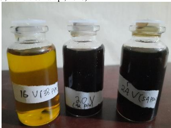
Gambar 3. Warna nanopartikel perak metode elektrolisis dengan konsentrasi berbeda-beda
