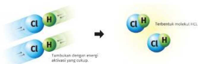
Gambar 4. Tumbukan molekul gas Hidrogen dan gas klorin yang efektif sehingga menghasilkan reaksi dan membentuk molekul baru. (Sumber: Ramli, 2022).
